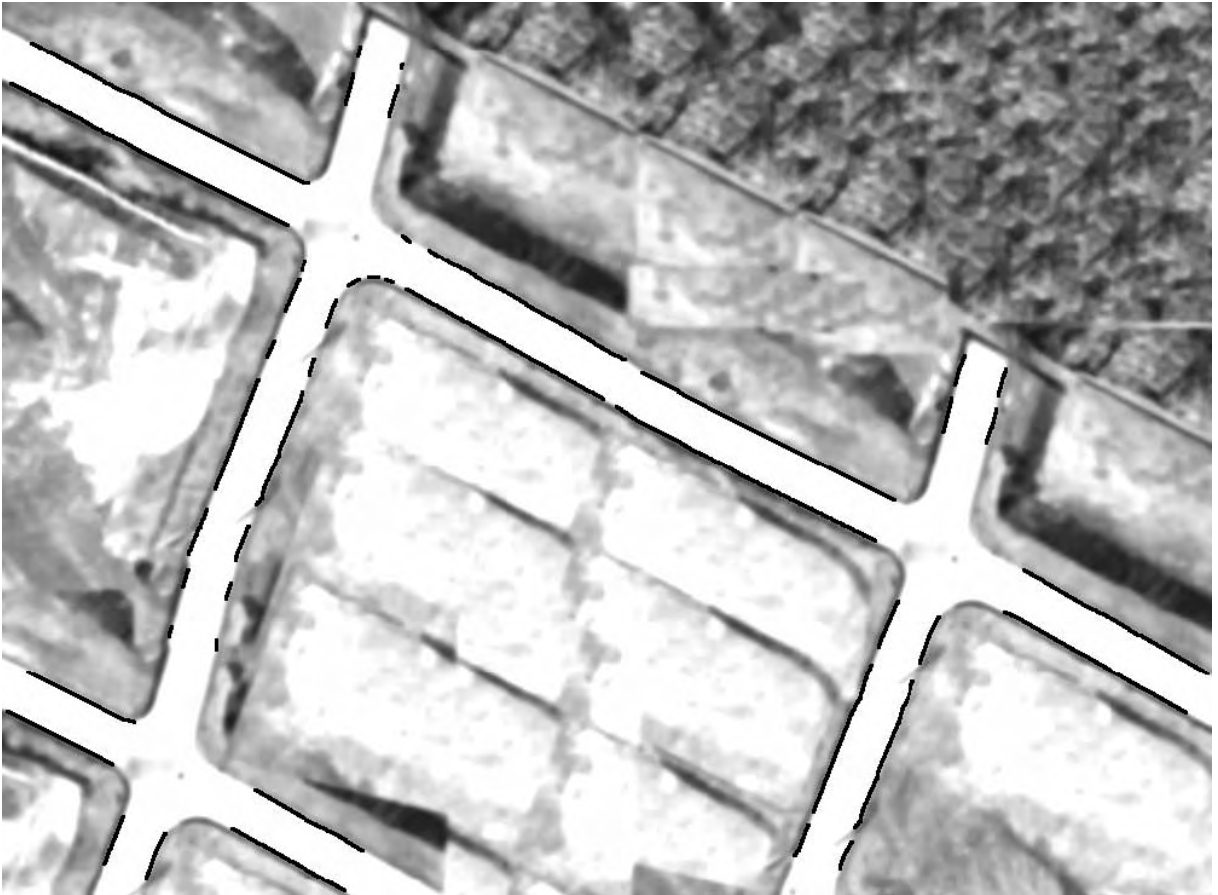
Figura 43. Resultado do processo de extração de rodovias com segmentos de rodovias delineados em preto.
