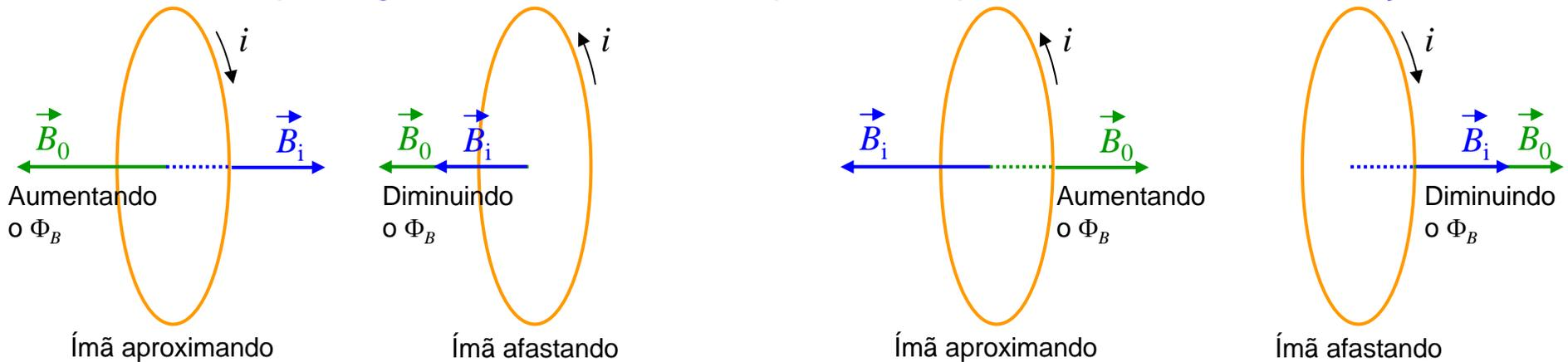
Ímã com pólo Norte voltado para bobina
