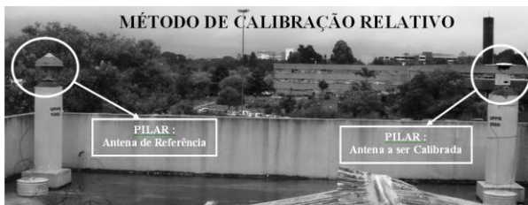
Figura 2 - Método de Calibração Relativo na BCAL/UFPR
