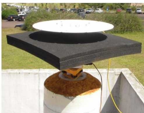
Figura 5 – 1º Protótipo do Atenuador do Efeito de Multicaminho (AEM -LAGEH) Fonte : VISKI (2010)
