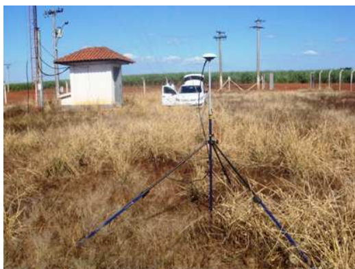
Figura 1 – Base utilizada para a inferência dos parâmetros de atividade da ionosfera.
