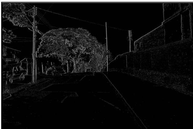
Figura 5 – Detecção de bordas da Figura 1a com o operador mmgradm.
