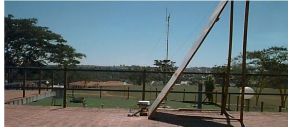
Figura 1 - Placa de ferro de 1,2 x 3,0 metros a 10 cm de distância da antena do receptor.
