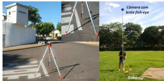
Figura 5: Forma de aquisição das cenas terrestres georreferenciadas.
